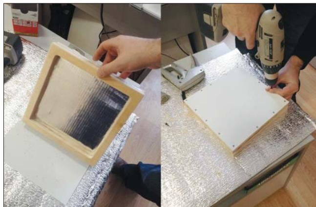
Рис. 3. Изготовление экспериментального образца сэндвич-панели для исследований
