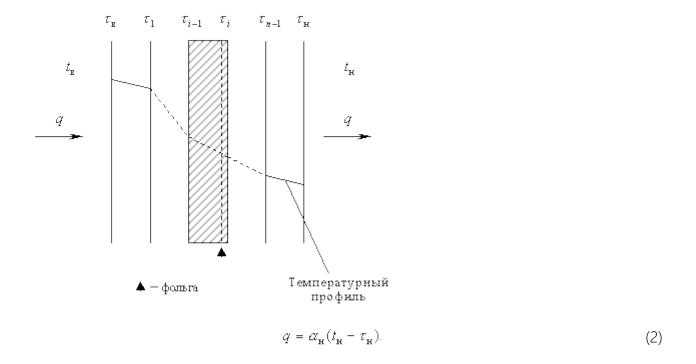
Тепловой поток, прошедший сквозь слой массивной изоляции определяется по формуле [Арнольд и др., 1979]:
